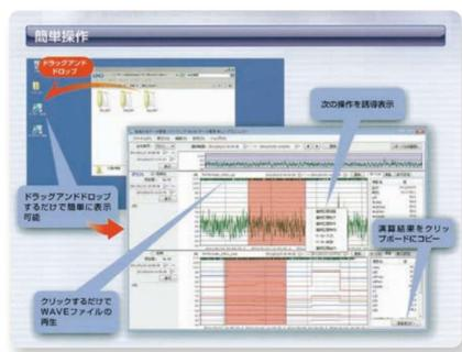
振動レベル計VM-53A・VM-55EXで測定したオートストアデータをパソコンで管理することが可能で、読み込んだ測定データのTime-Levelグラフの表示や複数チャンネルの同時表示・グラフの重ね書きや各種演算、帳票の作成が可能です。
